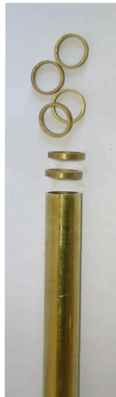
La macchina sega taglia tubo è stata studiata per ottenere sbocchi per la realizzazione di fedeli e anelli senza saldatura partendo da tubo.
