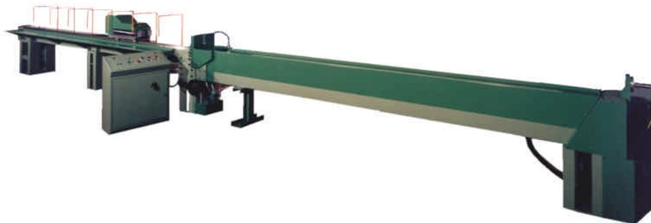
La macchina è composta da bancale in travi NP. 260 e avanbanco dove è racchiuso il cilindro idraulico.
