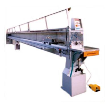
HEIGHT 1600mm WIDTH 110mm LENGTH 1000mm DRAWING POWER 2500 Kg SPEED OF DRAWING ADJUSTABLE FROM 0 TO 20m/1' TAKEN PLIERS AND TRACTIVE BARS: pneumatically CHAIN HITCH FOR THE SLIDING TROLLEY: pneumatically USEFUL STROKE TROLLEY 8,5 mt. SPEED OF RETURN TROLLEY 40m/1' TURNS: 0-1500/ 1 VARIABLE POWER SUPPLY 11 kW POWER SUPPLY 0F THE TROLLEY 1,1 kW FEEDING 380 Volt
